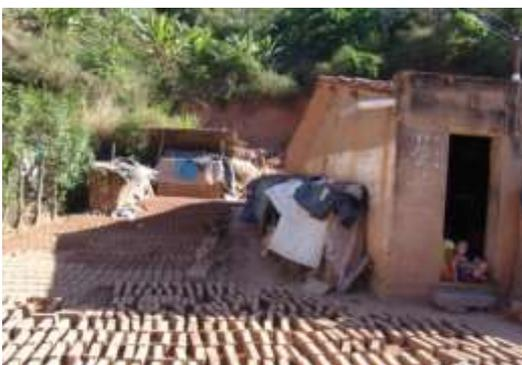
Figura 13: Secagem dos tijolos crus.
