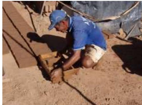
Figura 12: Desmoldagem.
