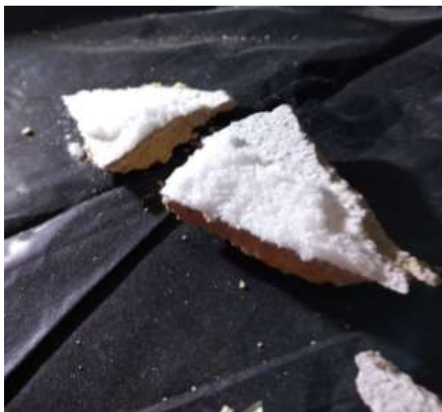
Fig. 5. Fragmentos de reboco demolido, o aspecto felpudo é dado pelos cristais de sal na superfície.
