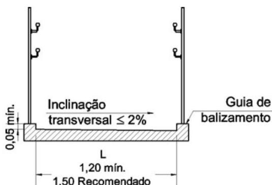
**FIGURA 5:** Inclinação transversal e largura de rampas
