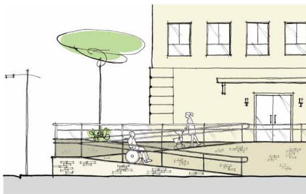
**FIGURA 16:** Acesso seguro a um edifício através de rampas com corrimãos e guarda-corpo
