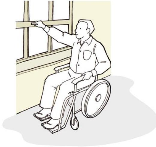
**FIGURA 22:** Sistema de alavanca adequado permite que um cadeirante abra uma janela com facilidade
