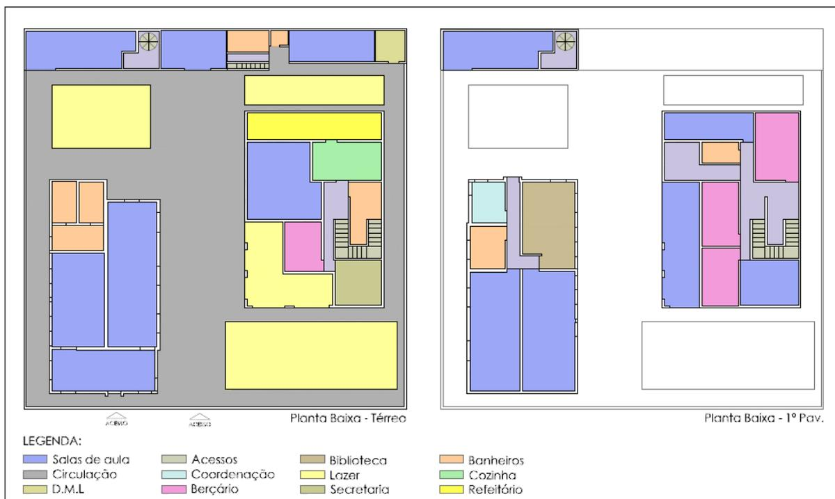
**FIGURA 57:** Planta baixa esquemática - térreo e 1º pavimento
