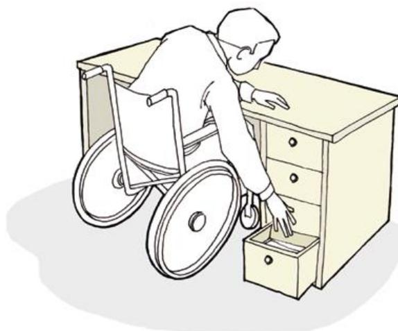
**FIGURA 23:** Mobiliário adequado permite que um cadeirante tenha acesso a todos os compartimentos com conforto e segurança
