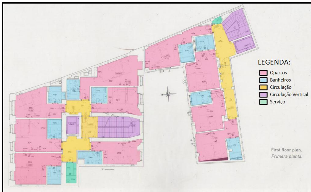
Figura - Planta baixa do primeiro pavimento do Hotel Moods, onde se encontram os quartos, sendo possível ver como eles estão distribuídos na edificação.
