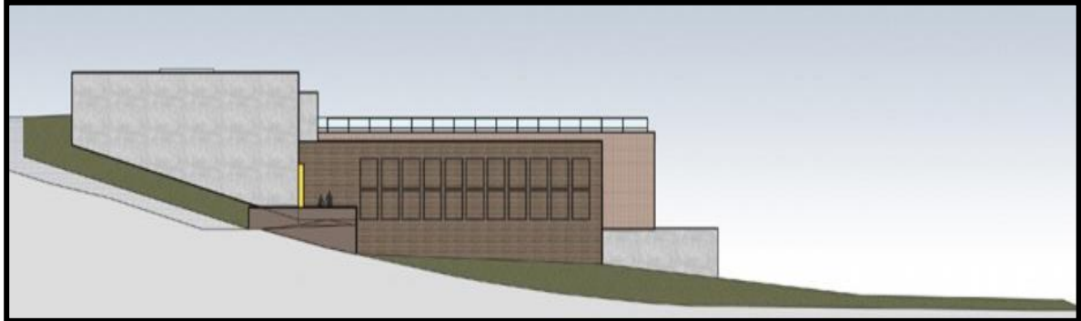
FIGURA 27: Fachada lateral Eco Mercado Palhano, mostrando a rampa acessível da entrada principal.
