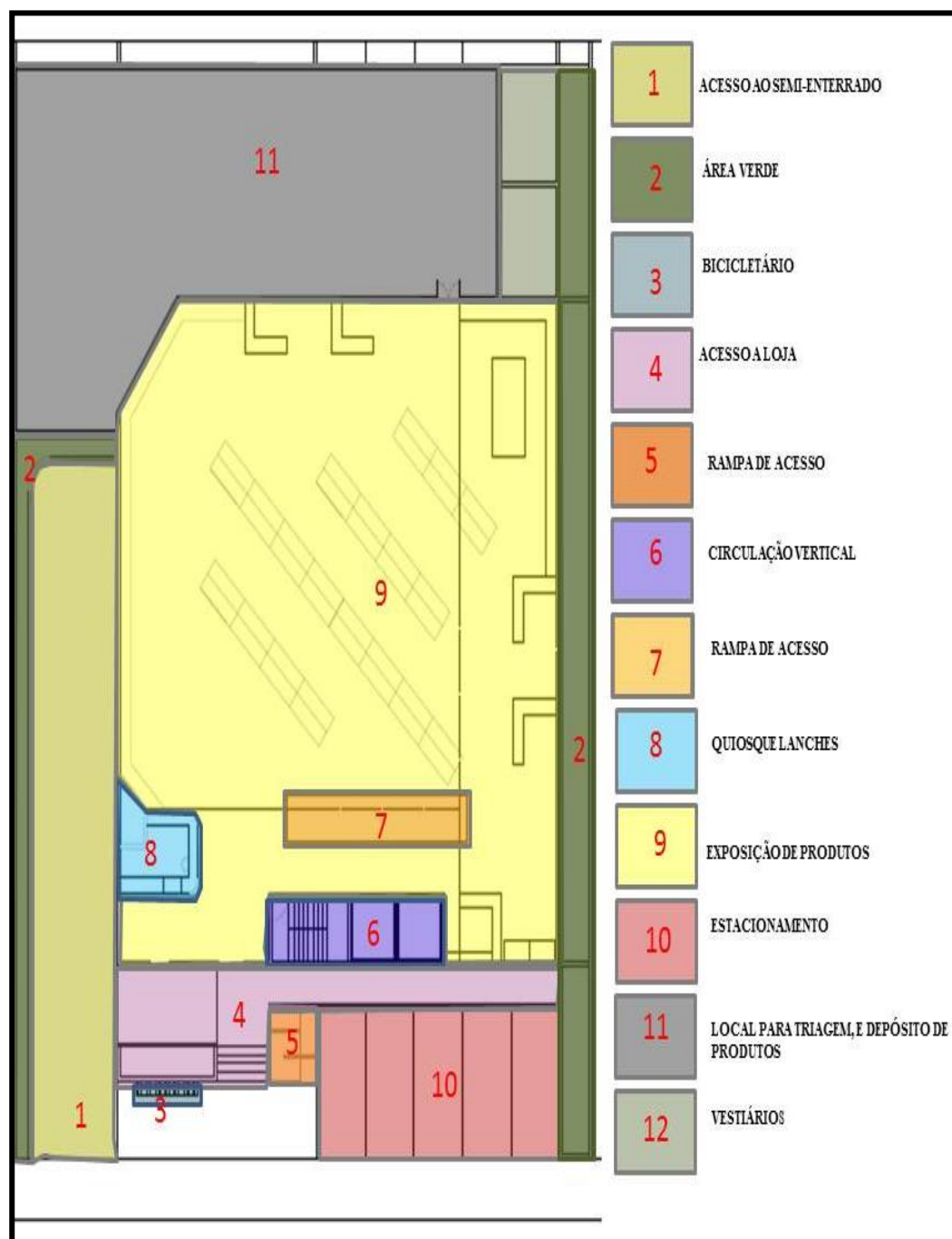
FIGURA 57: Planta baixa Esquemática do Primeiro Pavimento, demonstrando a área predominante de exposições de produtos.
