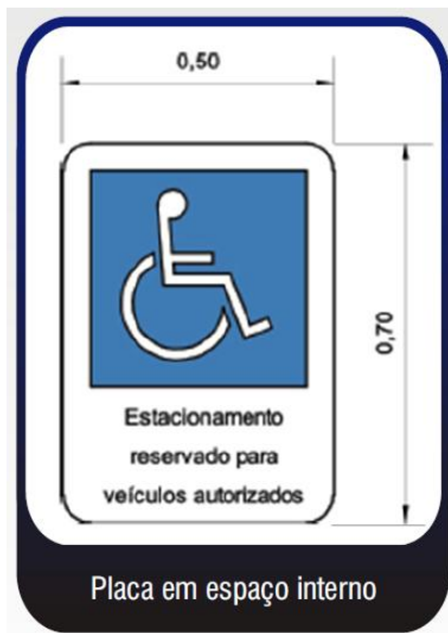
FIGURA 30: Placa de sinalização para estacionamento acessível
