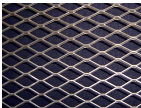
FIGURA : Chapas em aço galvanizado, cortadas e posteriormente tracionadas transversalmente.
