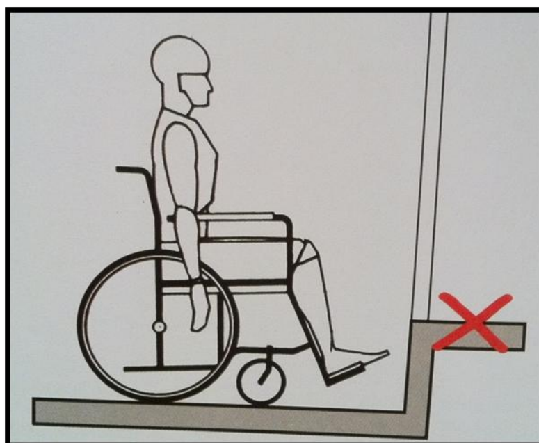
FIGURA 2: Exemplo de obstáculo para usuário de cadeira de rodas. FONTE: Silvana Cambiagui, 2007.
