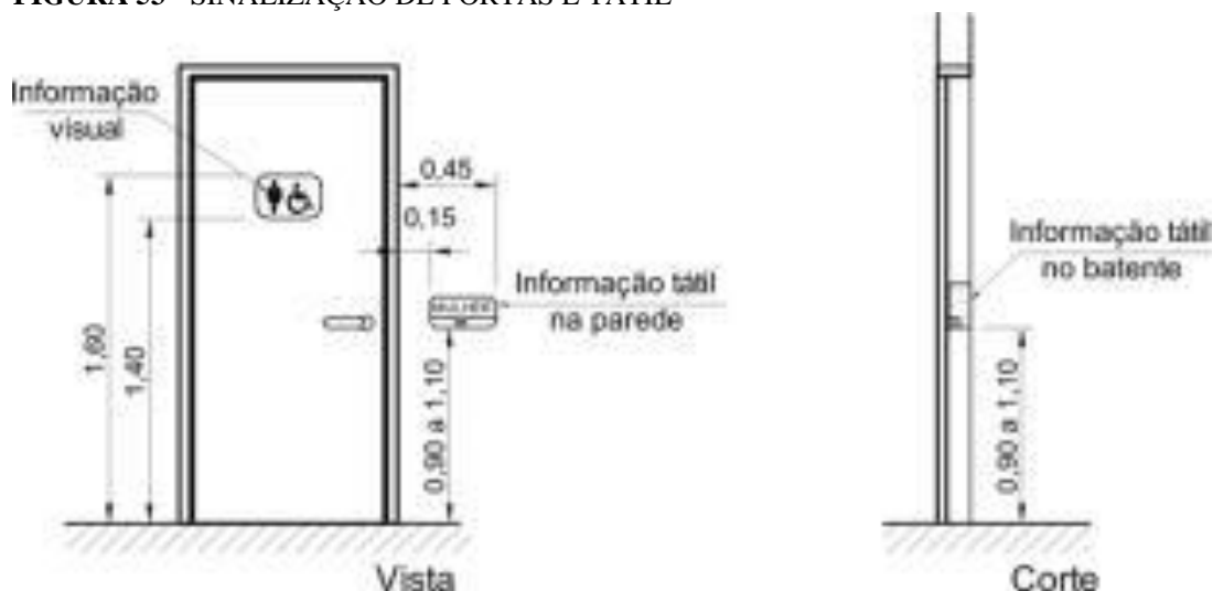
FIGURA 53 - SINALIZAÇÃO DE PORTAS E TÁTIL
