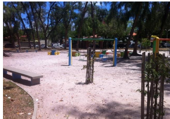
FIGURA 51: Piso em areia comprometendo o acesso de pessoas deficientes. FONTE: Autora, 2015.
