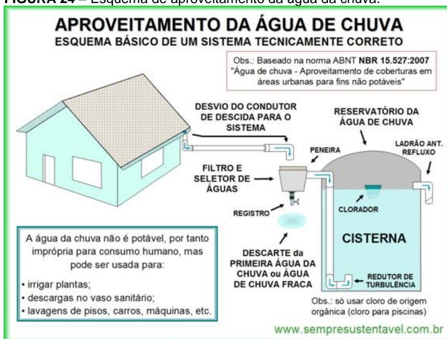
FIGURA 24 – Esquema de aproveitamento da água da chuva.
