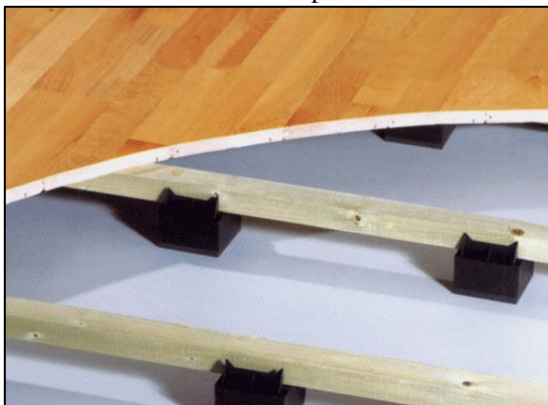
FIGURA 16 - Estrutura do piso flutuante.
