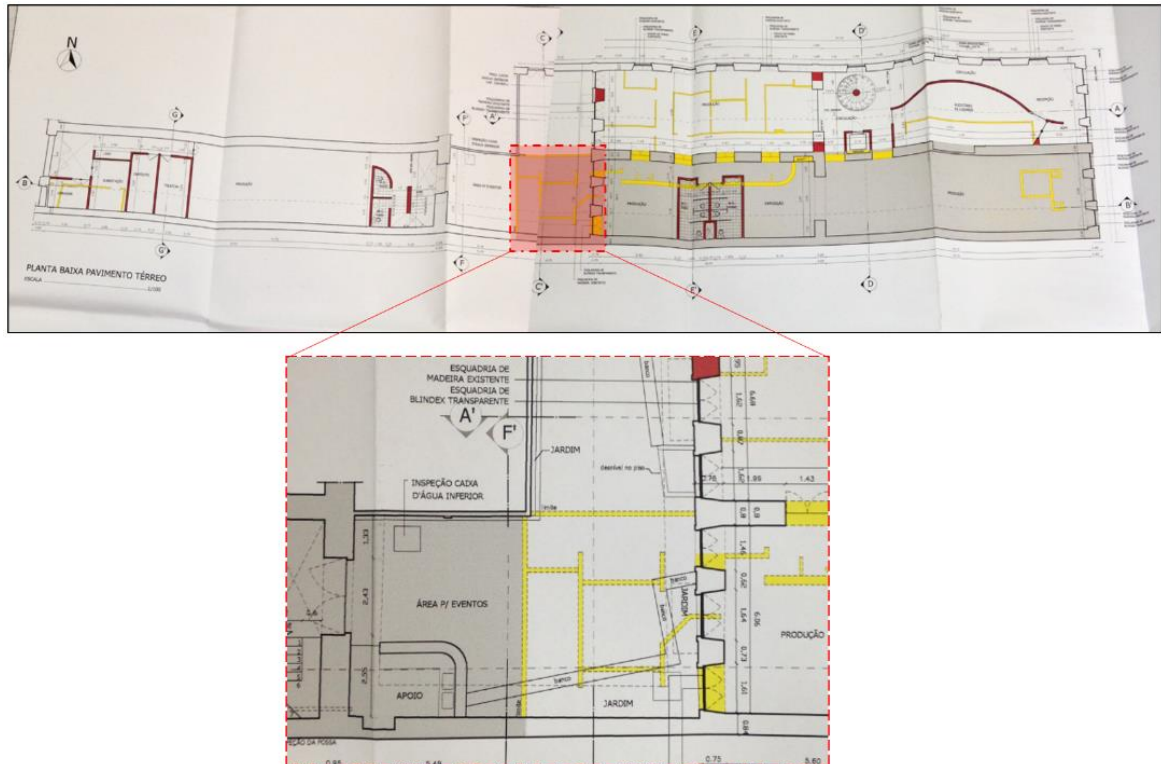
Figura 100 - Interligação dos imóveis através da demolição da parede em alvenaria
