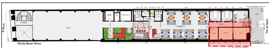
Figura 39: Pavimento térreo - planta baixa com destaque para área de geradores e subestação
