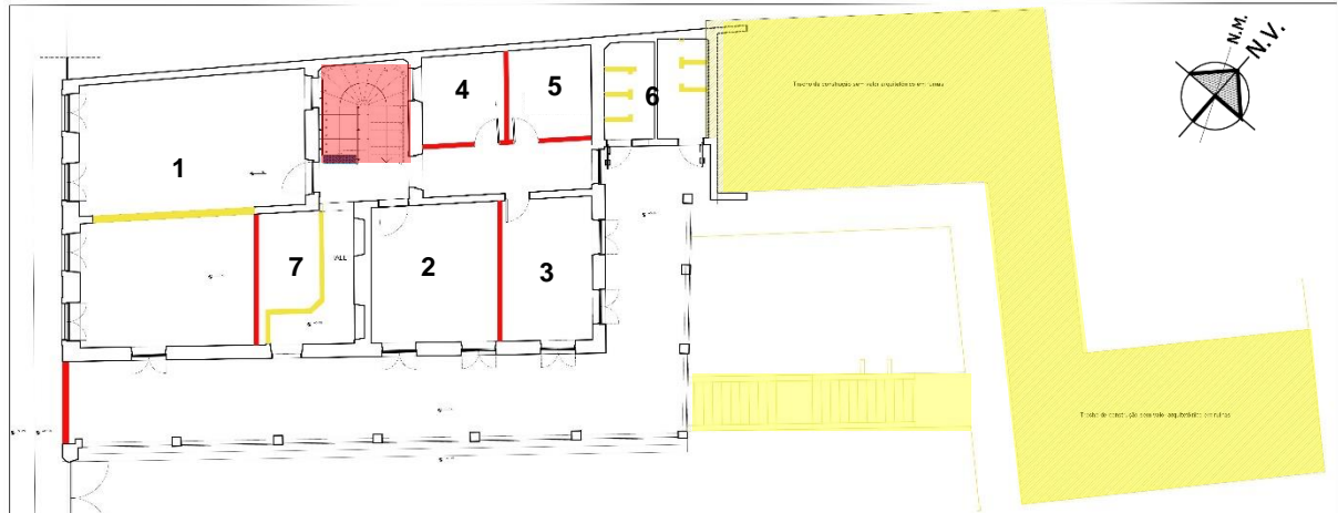
Figura 59 - Construir e demolir pavimento térreo
