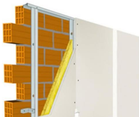
Figura 30: Parede de alvenaria com drywall .
