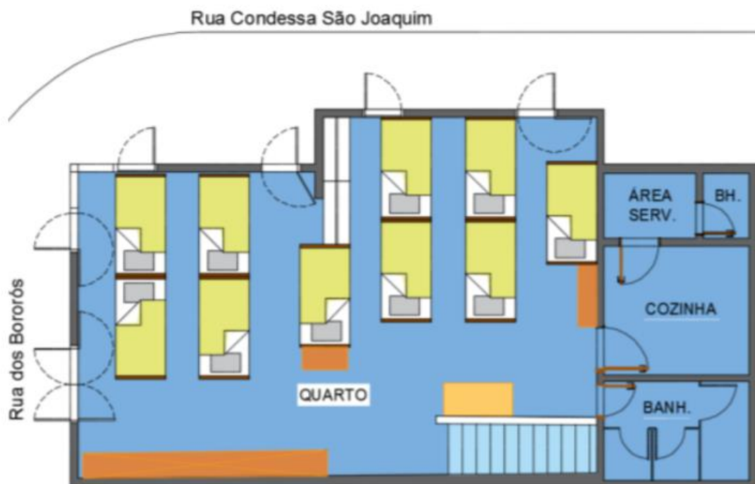
Figura 17: Croqui do primeiro pavimento do sobrado.
