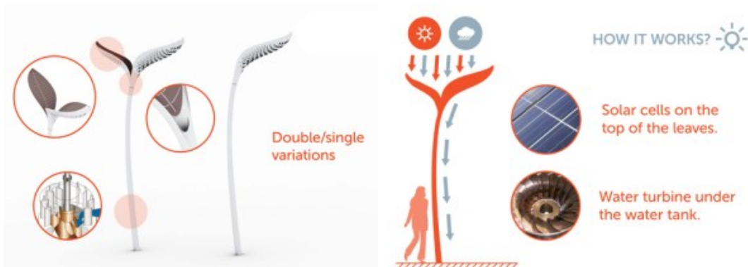
FIGURA 142: Funcionamento do poste “mango”.
