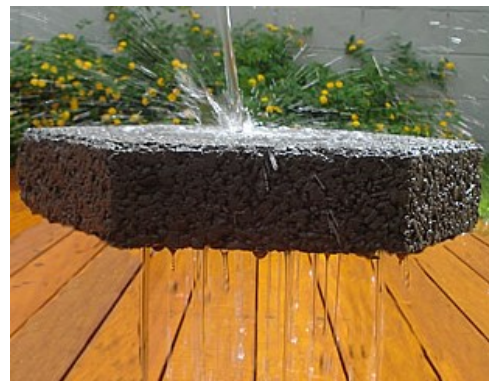
FIGURA 156: Demonstração da drenagem.
