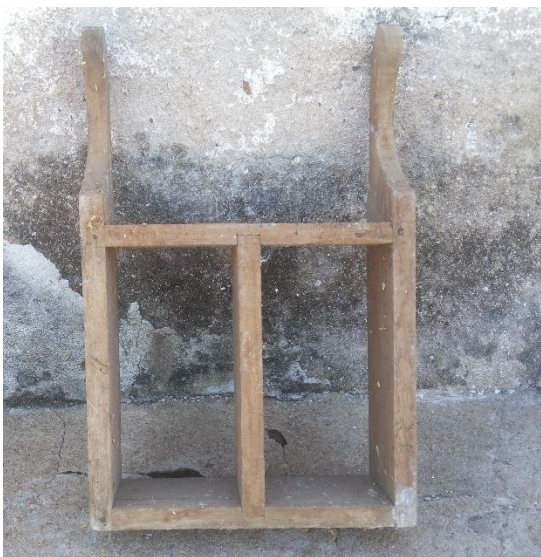
FIGURA 163 – Forma utilizada na confecção dos tijolos
