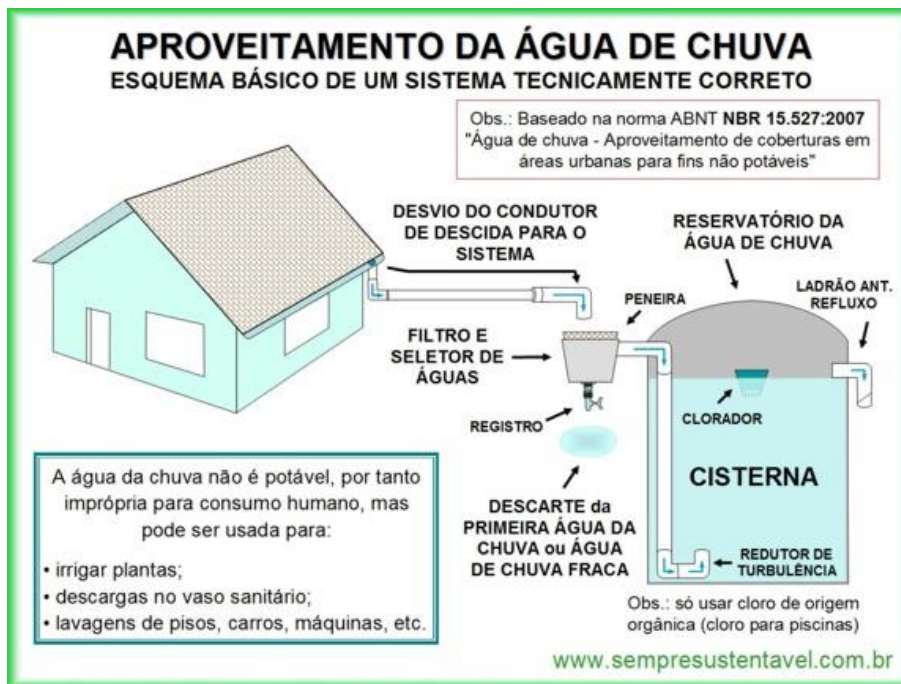
FIGURA 8 – Esquema básico de um sistema tecnicamente correto.
