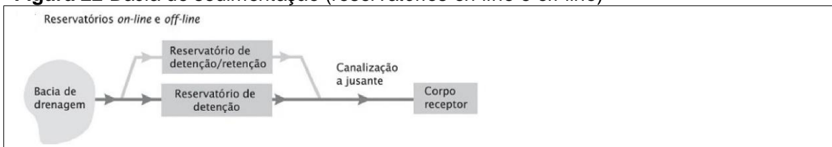
Figura 22- Bacia de sedimentação (reservatórios on-line e off-line)
