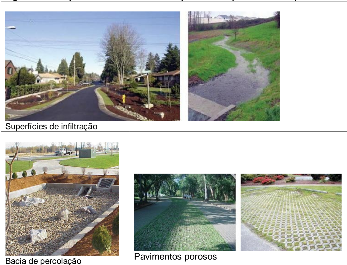
Figura 16 -Ilustração dos conceitos de canalização x reservação: Métodos dispersivos
