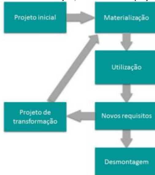
Figura 33 – Ciclo de vida de uma edificação, no contexto do projeto para a sustentabilidade.
