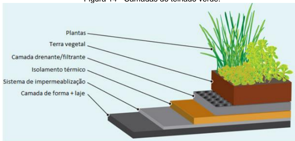
Figura 14 - Camadas do telhado verde.
